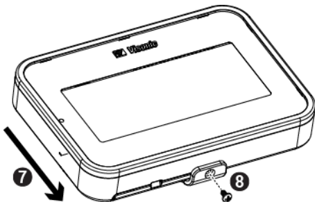
Abb. 5 – Wandmontage mit externen Gleichstromkabel
